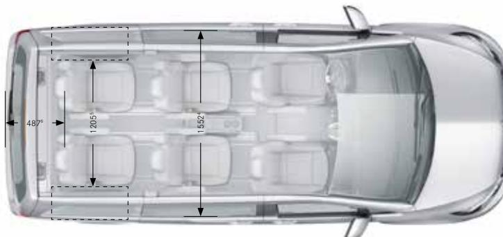
Svi podaci su u mm. Prikazane vrednosti predstavljaju prosečne vrednosti. Važe za vozila sa osnovnom opremom, bez opterećenja. <sup>1</sup>Visina vozila u kombinaciji sa krovnim nosačima u dodatnoj opremi dodatnih 48 mm
